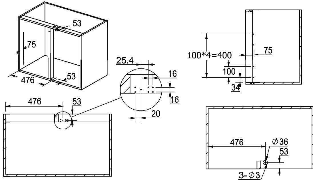
4. Прикрепите детали "J" винтом "E", затем детали "A" вверху и "B" внизу винтом "F".
