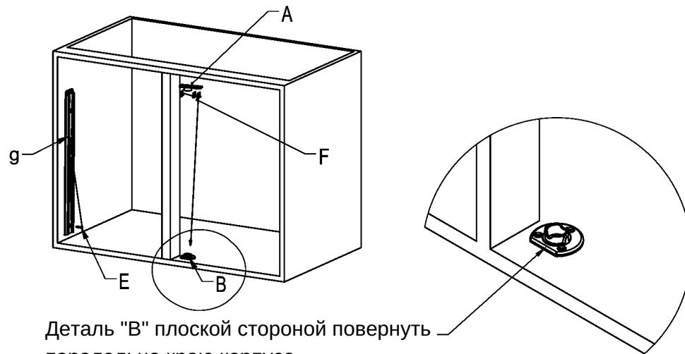
5. Закрепите детали "D" в деталях "C", затем вставьте в детали "B". Отрегулируйте часть "C" на подходящую высоту и зафиксируйте ее.
